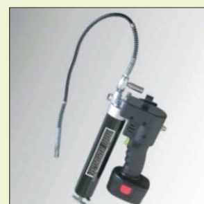
Rasvauslaite on varustettu ylipaineventtiilillä, ilmauspainikkeella sekä täyttöpumpulla
